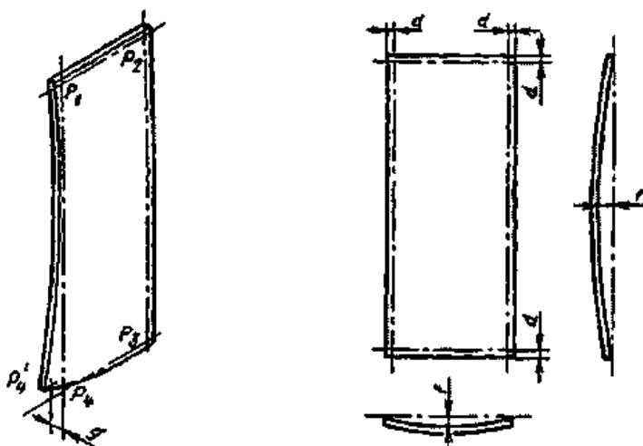
Відхилення від прямолінійності кромок деталей повинен перевищувати 1,0 мм на 1 м довжини будь-якої ділянки елемента дверного блоку. (Йдеться про відхилення пов'язані з вигином торців і кромок полотен).
